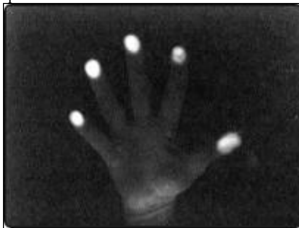
Figura 22- Detecção da interação por monitoramento de imagem em infravermelho [Nuigroup, 2010].
